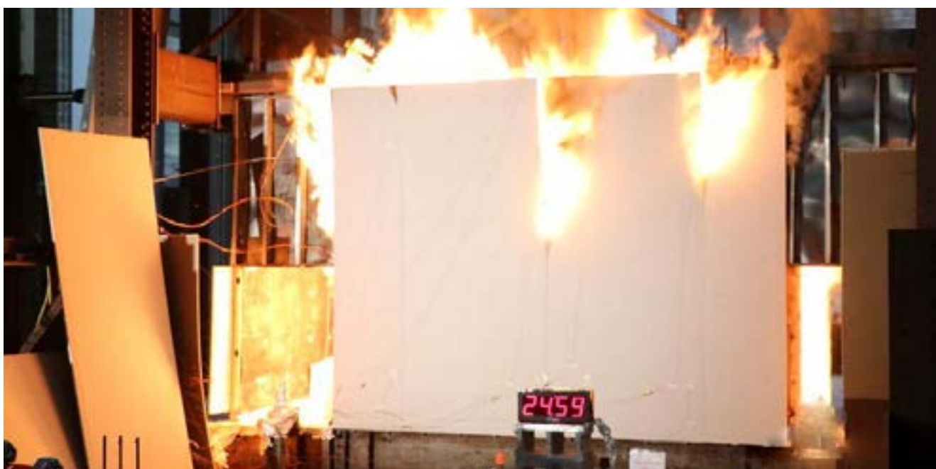
Kiểm tra khả năng chống cháy rèm cuốn chống cháy
